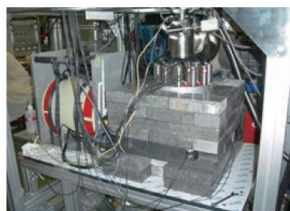
オンライン同位体分離装置に設置した全吸収型放射線測定装置
